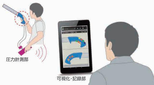
図1 圧力分布可視化システムの使用イメージ
