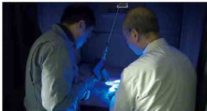
紫外線によるキズの確認(浸透探傷)
