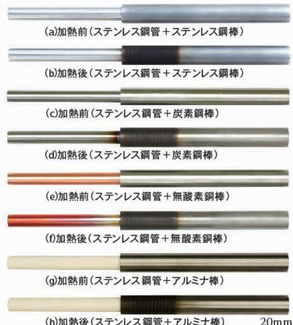
図2 レーザ加熱前後の試験片
