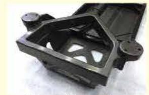
EV車用CFRP軽量化シャーシ
