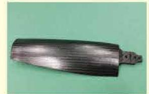
空飛ぶクルマ用CFRPプロペラ
